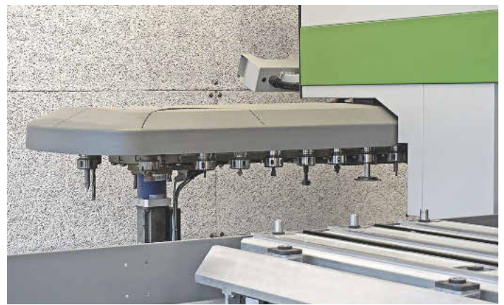
/ Die Biesse-5-Achs besticht durch 33 Werkzeugplätze und ein EPS-Tischsystem. Seit 2015 ist sie das Herzstück der Schreinerei und läuft mehr als 20 Stunden die Woche.
