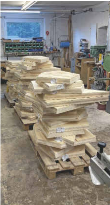
/ Der Stoff, aus dem die Traumhütten gemacht sind: 8 cm starke X-LAM-Platten, Wabe für Wabe in Form gesägt.
