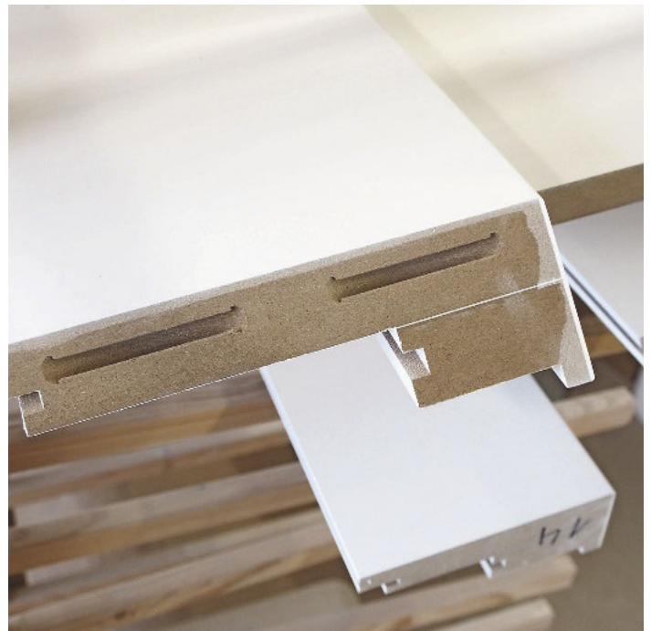
/ Auch die Fräsungen für Lamellos Clamex-P-Verbinder werden auf dem Homag-Bearbeitungszentrum beliebig vorgenommen.
