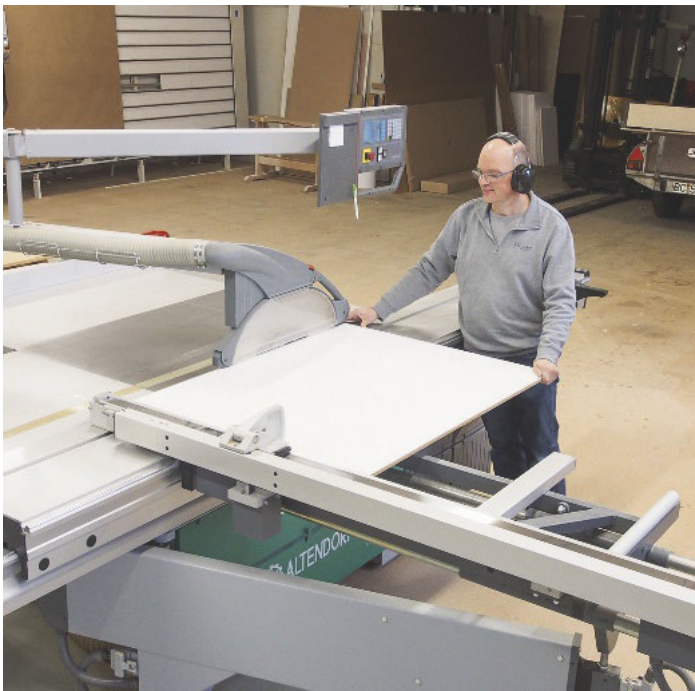
/ Der Plattenzuschnitt erfolgt in der Schreinerei konventionell gemäß Schnittoptimierung auf einer Altendorf-Formatkreissäge F45 Elmo.
